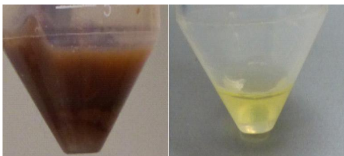
Рис. 3 Однорідна суміш молочного шоколаду та 1-бромнафталіну перед фільтруванням (зліва) та після (справа).
