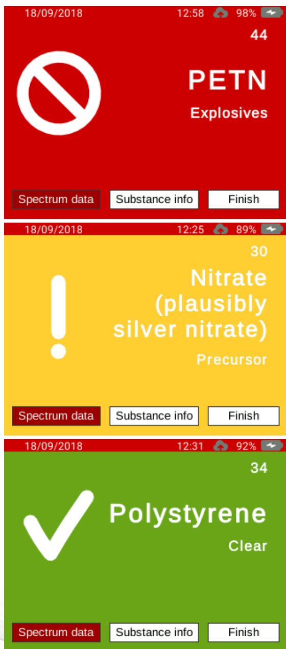
Рисунок 2: Результаты измерений различных веществ. Интуитивно понятная цветная кодировка позволяет прямо на месте проводить быструю оценку наличия в образце незаконного вещества. ПЭТН (взрывчатый, красный), нитрат серебра (прекурсор ПЭТН, желтый), и полистирол (чистый, зеленый).
