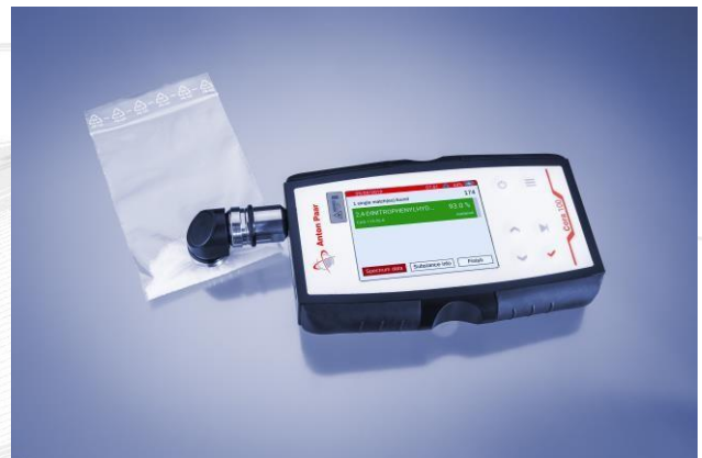
Рисунок 1: Идентификация наркотических препаратов с помощью рамановского спектрометра CoRa 100, Anton Paar..
