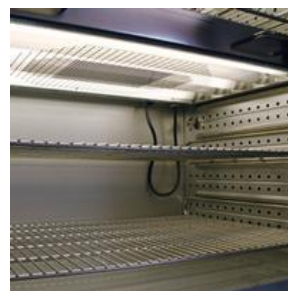
Освещение в соответствии с директивой ICH с 3 люминесцентными лампами светло-белого света и 2 лампами BINDER Synergie Light
