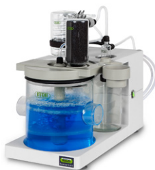
Scrubber K-415 Нейтрализация
