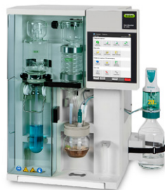
KjelMaster К-375 Паровая дистилляция и титрование
