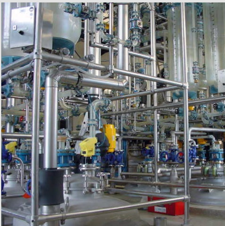
4000 liter BE reactor with coated glass upper section 4000 Liter BE Reaktor mit beschichtetem Glasaufbau
