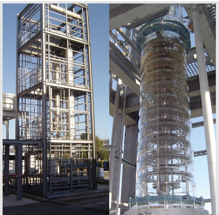
DN400 liquid / liquid extraction column, capacity 800kg/h DN400 flüssig / flüssig Extraktionskolonne, Kapazität 800kg/h
