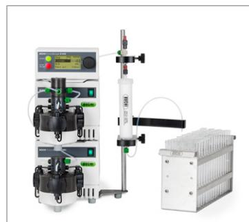
Система очистки Sepacore® Easy Extract идеально подходит для дополнительной очистки сложных экстрактов перед анализом.
