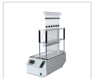
Анализ следов металлов проводится с помощью дигесторов с обратным холодильником, даже если требуется большой объем образца (пробирки 300 мл).
