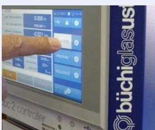
Setting of leak test parameters / Einstellung der Leckage Testparameter
