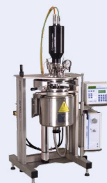
«versoclave» ■ 0.5 – 5.0 L, 200 bar / 250 °C Stirrer drive / Antrieb: 0 – 2000 rpm
