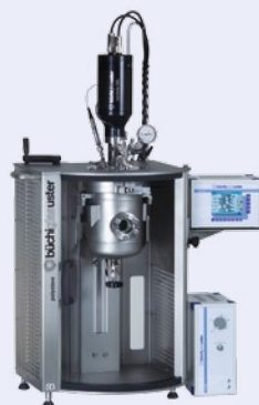
«polyclave» ■ 0.25 – 5.0 L, 12 bar / 200°C ■ 0.50 – 5.0 L, 200 bar / 250°C Stirrer drive / Antrieb: 0 – 2000 rpm
